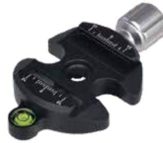
DM-55N 尺寸: 90*52*15mm 自重: 58g 卡槽: 阿卡雅佳 底部螺丝孔: 3/8"
