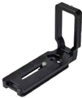
MPU-100L 尺寸: 108*38*75mm 自重: 100g 燕尾槽: 阿卡雅佳 快装板螺丝: 1/4"
