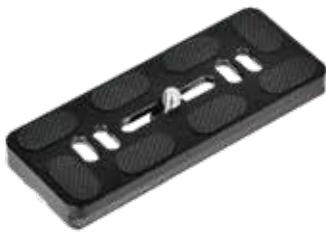
PU-100 尺寸: 100*38*10mm 自重: 52g 燕尾槽: 阿卡雅佳 快装板螺丝: 1/4"
