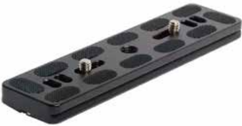
PU-150 尺寸: 150*38*10mm 自重: 87g 燕尾槽: 阿卡雅佳 快装板螺丝: 1/4" & 3/8"
